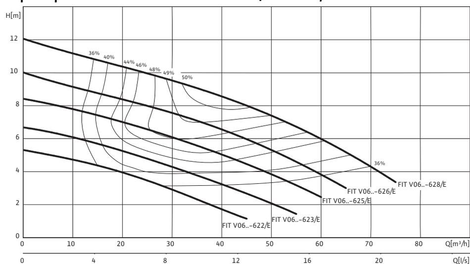
Характеристики согласно ISO 9906, приложение А. Указанный коэффициент полезного действия соответствует гидравлическому коэффициенту полезного действия.
