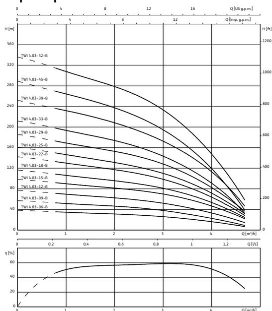
3~400 В, 50 Гц,  $\rho = 1 \text{ кг/дм}^3$ ,  $\nu = 1 \times 10^{-6} \text{ м}^2/\text{с}$ , ISO 9906 приложение А,  $\eta = \text{КПД}$  насоса
