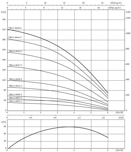
$1\sim$  230 В или  $3\sim$  400 В, 50 Гц, p = 1 кг/дм3, v = 1х10-6 м2/с, ISO 9906 приложение A,  $\eta$  = КПД насоса
