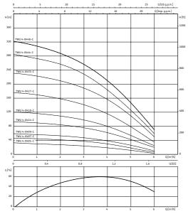
$1{\sim}230$  В или  $3{\sim}400$  В, 50 Гц, p = 1 кг/дм3, v = 1x10–6 м2/c, ISO 9906 приложение A,  $\eta$  = КПД насоса
