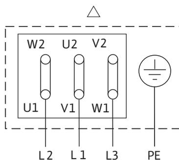
Δ: Схема соединения – треугольник
